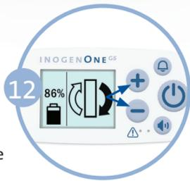
Premere e tenere premuti i pulsanti più (+) e (-) meno per 5 secondi. Lo schermo visualizzerà il messaggio "sieve reset" (reset filtro). Rilasciare i pulsanti una volta visualizzato il messaggio sullo schermo.
