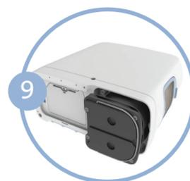
Inserire il gruppo colonnine nel concentratore Inogen One® G5. Non lasciare esposte le estremità delle colonnine; il gruppo colonnine dev'essere inserito nell'Inogen One® G5 non appena rimosse le coperture antipolvere.
