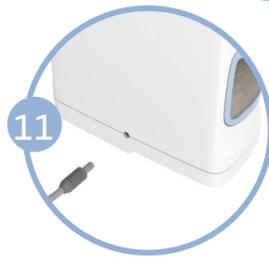
Collegare il cavo di alimentazione ca a Inogen One® G5 e collegare il cavo di alimentazione ca a una presa elettrica. Non accendere il concentratore Inogen One® G5.
