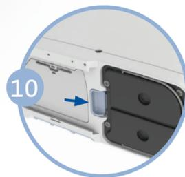
Spingere il gruppo colonnine nel dispositivo in modo che le colonnine siano completamente collocate nel concentratore Inogen One® G5. Il pulsante di blocco a molla deve tornare completamente alla posizione inserita.
